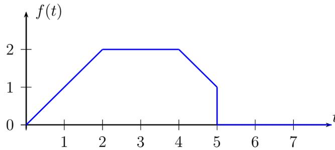
Esboce o gráfico da derivada  $g(t)$  desta função e calcule as Transformadas de Laplace  $F(s)$  e  $G(s)$ .
