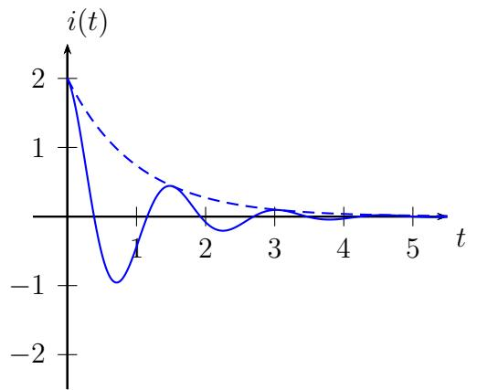
A equação da envoltória, esboçada com uma linha pontilhada, é  $2e^{-t}$ . Assinale as alternativas que indicam, respectivamente, a frequência do sinal e a transformada de Laplace  $I(s) = \{i(t)\}$ .
